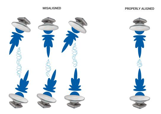
Fig. 4. Antenna alignment scenarios.
